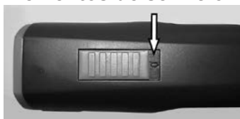
Fig. 4 Interrupteur posición DESCO. ("0")
