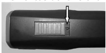
Fig. 4 Interruptor em posição OFF ("0")
