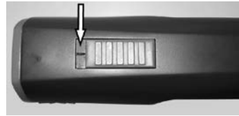
Abb. 5 Schiebeschalter in EIN-Position („I“)
