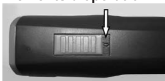
Fig. 4 Interrupteur position arrêt (« 0 »)
