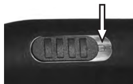
図. 12 スイッチON位置(「II」) 装置の高速ステージ
